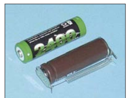
Bild 5: Der Sensor TGS5042 besitzt die Form und Größe einer Mignonzelle. Foto: Sander
