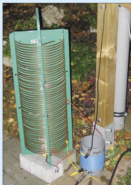
Bild 15: Spule aus 4,5 mm dickem Kupferdraht und daneben Variante aus 1,5-mm 2 -Installationsdraht
