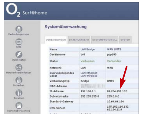
Bild 10: Beim UMTS-Router von O2 ist die aktuelle IP-Adresse in der Systemüberwachung nachzulesen. Screenshots: DD6AE
