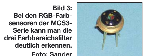
Bild 3: Bei den RGB-Farbsensoren der MCS3-Serie kann man die drei Farbbereichsfilter deutlich erkennen. Foto: Sander
