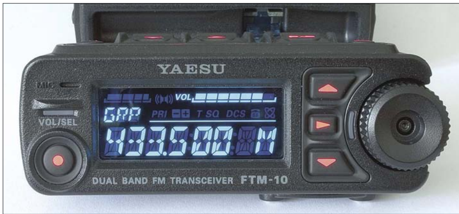
Bild 1: Der FTM-10E hat ein blau leuchtendes Display, das auch bei hellem Umgebungslicht noch gut ablesbar ist.
