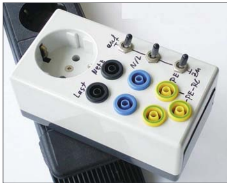
Bild 1: Ein einfach aufzubauender Messadapter lässt sich zwischen Steckdose und Gerät einschleifen, ohne bei Strommessungen Leitungen auftrennen zu müssen.
