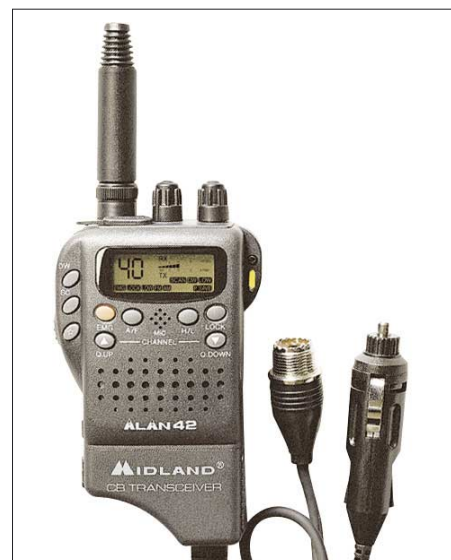
Zum Lieferumfang beider CB-Handsprechfunkgeräte gehört eine Mobileinheit zur Versorgung aus dem 12-V-Kfz-Bordnetz und zum Anschluss einer externen Antenne. Beim Alan 42 ersetzt der ansteckbare Mobiladapter das Batteriegehäuse.
