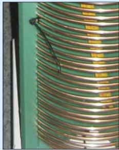
Bild 11: Teil der fertig-gestellten Spule mit abschließend wieder montierten Kunststoffleisten
