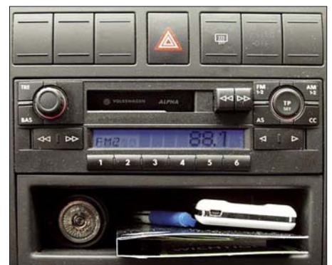
Bild 1: Original-Werksradio „VW Alpha“: Trotz Digitalanzeige kein Digitalradio, empfängt nur analog UKW und Mittelwelle.
